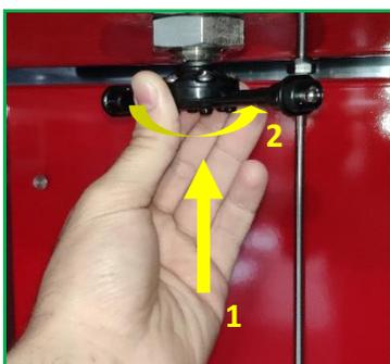
2. Dévisser le bras de lavage à la main. Laisser tremper dans le produit anticalcaire "ANTICA-ONE". Le remonter à la main une fois le nettoyage effectué.
