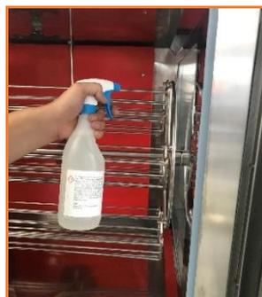
1. Pulvériser de l'anticalcaire "ANTICA-ONE" dans l'enceinte de la rôtissoire. Laisser agir et frotter à l'aide d'une éponge.
