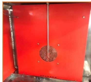
2. Avant de commencer, la rôtissoire doit être vide et l'écran tactile doit être sur la page d'accueil. Nettoyer le panneau et le fond en pulvérisant du produit "DECA-ONE" et en frottant à l'aide d'un grattoir.
